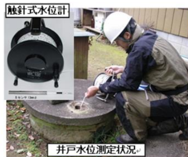
井戸水位測定の様子
