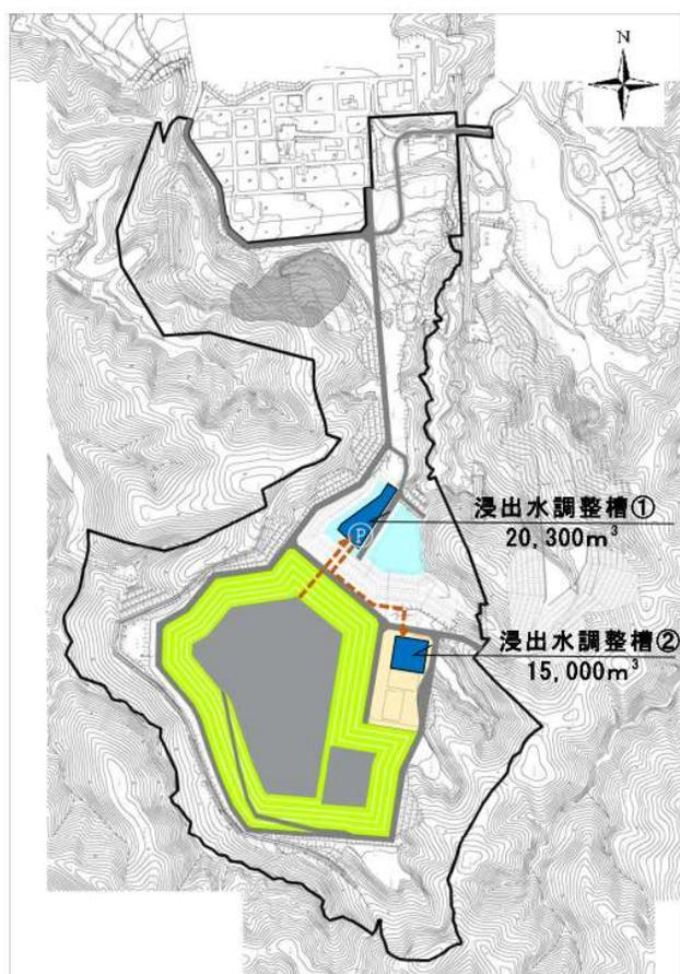
図 3.4.4 浸出水調整槽の基本配置
